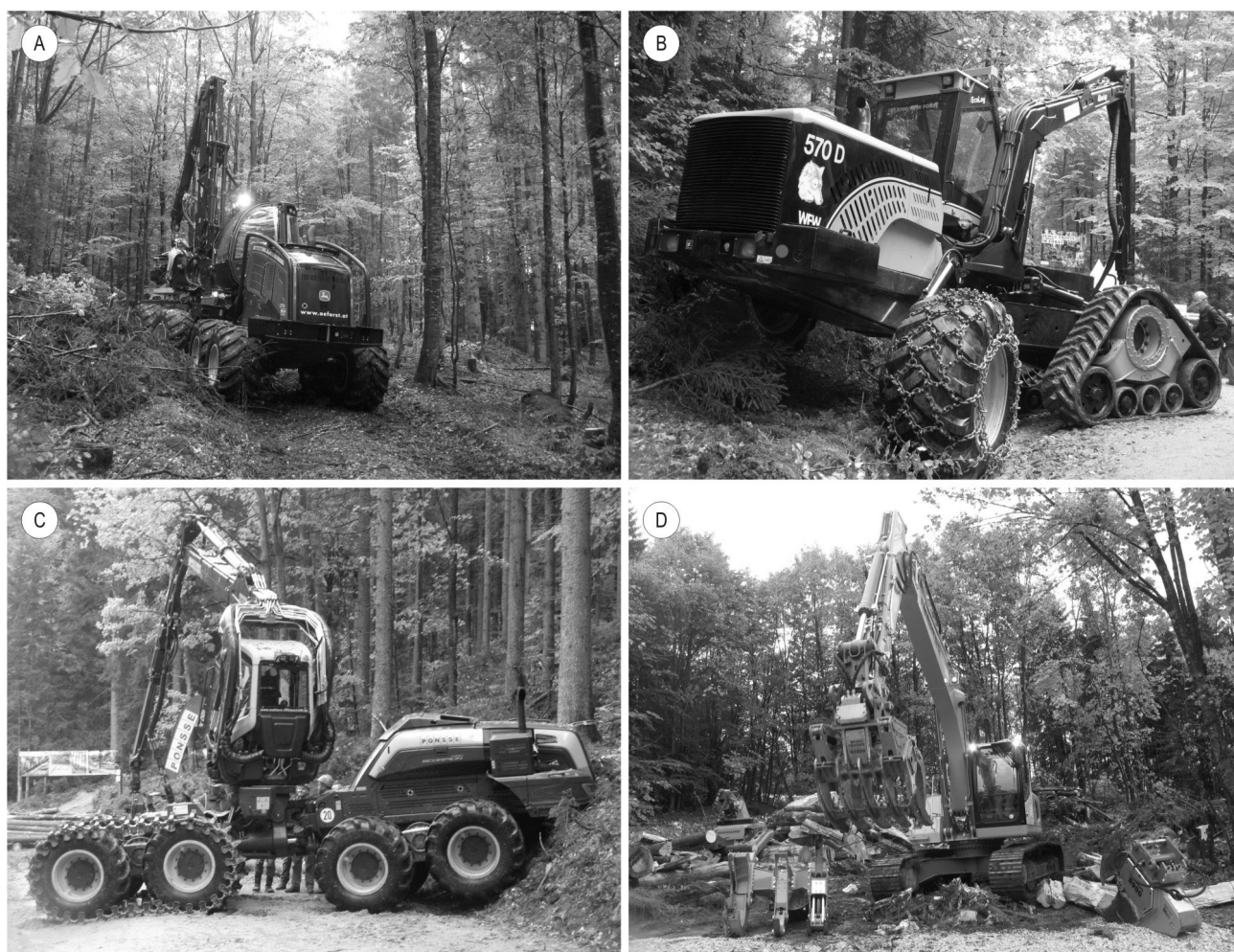
Slika 2. A) osmokotačni harvester John Deere; B) gusjenično-kotačni harvester WFW 570D; C) osmokotačni harvester Ponsse Scorpionking i D) bager s raznim inačicama cjepačkih glava Woodcracker
