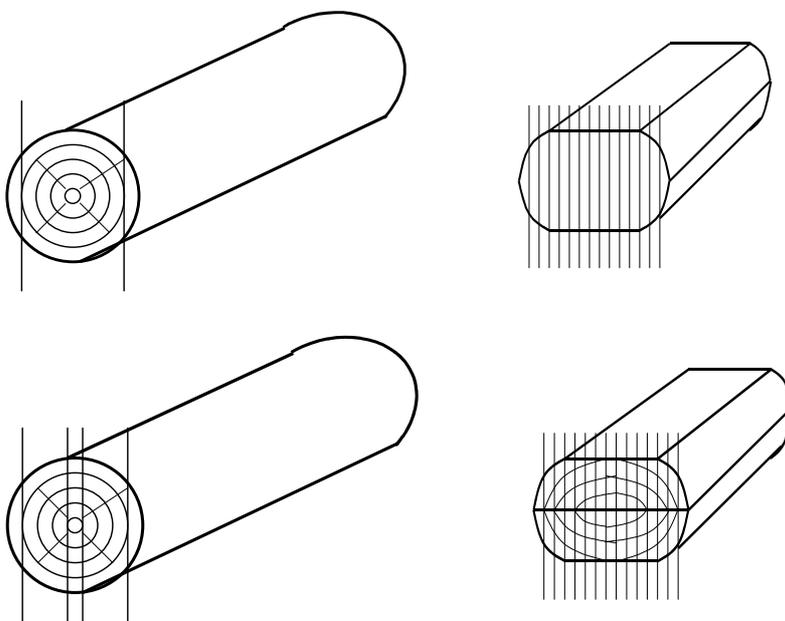
*b) Izradba okrajčenih piljenica primarnim raspiljivanjem trupaca u neokrajčene piljenice te sekundarnim raspiljivanjem tih piljenica na kružnoj pili (višelisne, jednolisne)*
