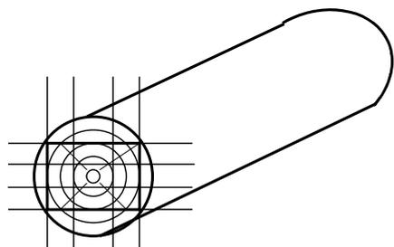
b) *Izradba gredica primarnim raspiljivanjem trupca u neokrajčene piljenice te sekundarnim raspiljivanjem tih piljenica na kružnim pilama (višelisne, jednolisne) ili tračnim pilama u gređice*
